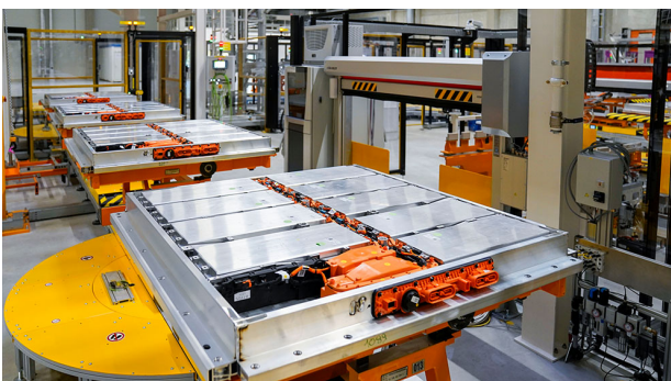
Hochautomatisiert: die Fertigung der Batteriesysteme für ID.3 und ID.4 bei Volkswagen Group Components Braunschweig
