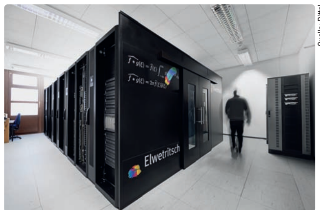
Elwetritsch schafft aktuell 53 Billionen Rechenoperationen pro Sekunde auf 240 Rechnern und hat einen Energiebedarf von 110 kW (Abb. 2).
