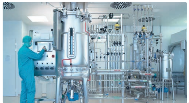
Ein Rührkesselfermenter im Labor von Rentschler Biotechnologie (Abb. 2)
