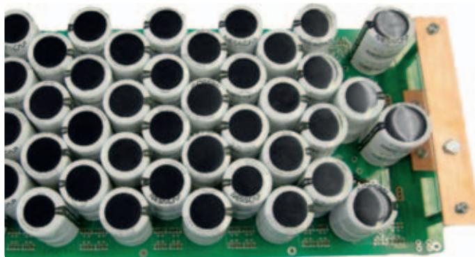
Superkondensatoren sind für Anwendungen geeignet, die sehr empfindlich auf kurzzeitige Stromausfälle reagieren.
