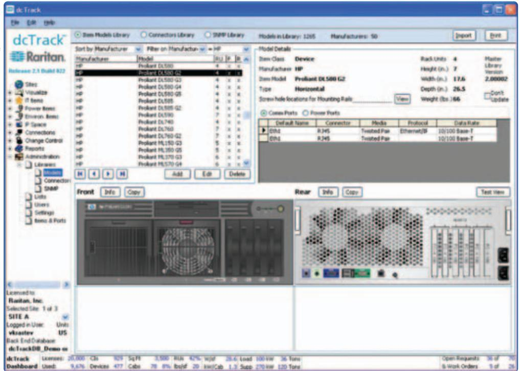
dcTrack liefert zu jedem Asset-Eintrag Informationen wie Herstellername, Modellinformation, Größe, Höhenheiten, Stromverbrauch und Wärmeabgabe und kann von jedem Gerät Vorder- und Rückansicht abbilden (Abb. 2).
